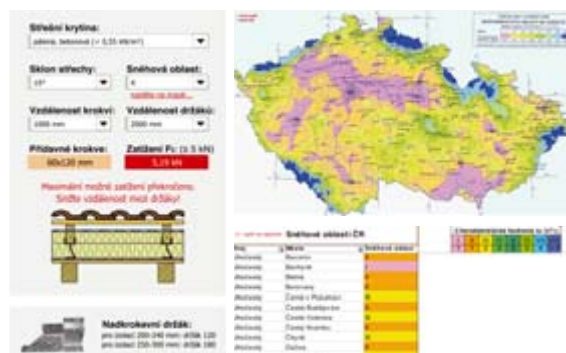
Způsob kontroly statických parametrů systému TOPROCK http://pruvodce.rockwool.cz/media/66990/toprock.xls (obr. 23)
